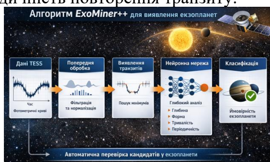
Рис. 3. Алгоритмічна схема автоматичного аналізу світлових кривих у системі ExoMiner.
