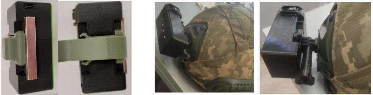
Рис. 6. Встановлення кріплення на освітлювальному пристрої
